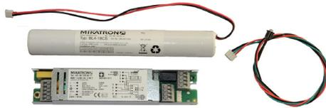
Universelles elektronisches Notlichtbetriebelement mit automatischer Selbsttestfunktion nach IEC 62034 einsetzbar für Dauer- und Bereitschafts-Modus. Leuchtmittel: T5, T8 und Kompaktleuchtstofflampen von 6 bis 80 Watt. Geeignet für alle gängigen elektronischen Vorschaltgeräte und KVGs.
